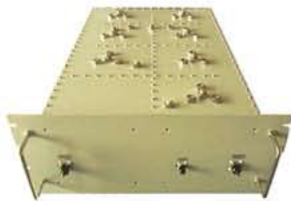
隣接除去用出力フィルターの例
